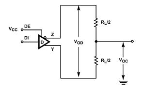
FIGURE 1A.  $V_{\mbox{OD}}$  AND  $V_{\mbox{OC}}$
